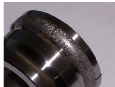
Износ шарикового подшипника
