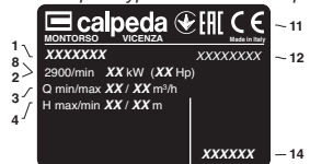
Beispiel Typenschild des Motors
