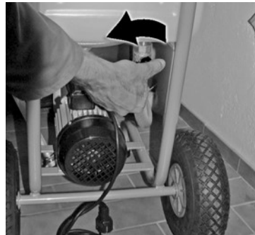
4. Заполните бак и откройте шаровой кран
