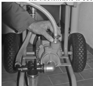
1. Подсоединить заправочный шланг к выходу элиминейтора®
